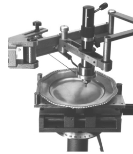
LH 410 E mit schwenkbarem, selbstzentrierendem Schraubstock + Haltevorrichtung für Teller ( gerade Gravuren ) und größere Schilder, etc., Best-Nr. 415/2
